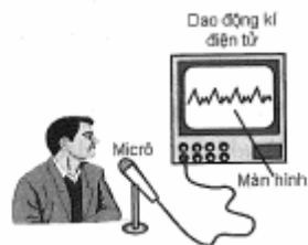
Hình 1 Dùng dao động kí điện tử để khảo sát dao động âm
